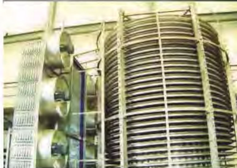
รูปที่ 1 แสดงตัวอย่างเครื่องแช่แข็งแบบอุโมงค์ (Tunnel Freezer) และเครื่องแช่แข็งแบบสายพานเกลียว (Spiral Freezer) ตามลำดับ
