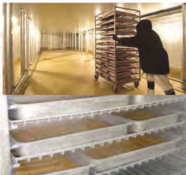
รูปที่ 2 แสดงตัวอย่างการฟรอสแบบเป็นรอบ (Batch Freezer)
